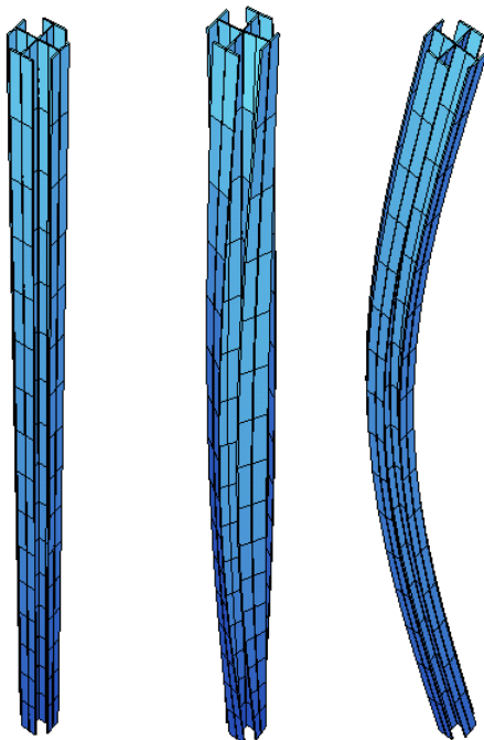
Abbildung 7: System und Beuleigenform (256 Elemente)
